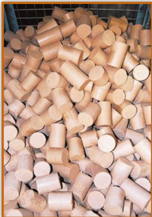
In einer modernen Schreinerwerkstatt stiebt nur wenig Sägemehl. Bei Weiss AG wird es direkt zu grossen Pellets gepresst und dient als Energieträger.
