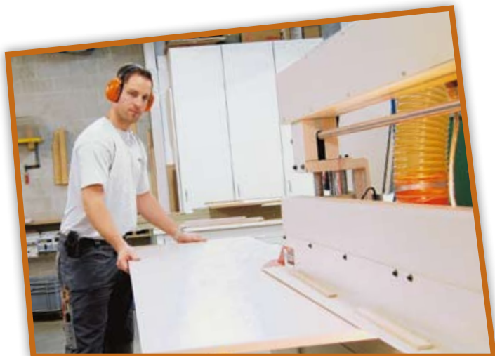
Spanplatten sind das wichtigste Material im modernen Küchenbau: Michael Loser am Kantenleimer.
